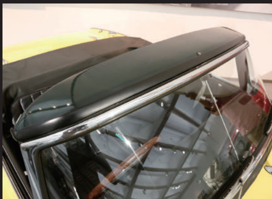
前擋風玻璃頂部的風擋板是專為敞篷車型設計的。在展開車頂時需要取下它。
