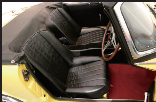
採用低背座椅的設計，考慮到敞篷狀態下的外觀。在S800M的最終型中，標配了三點式安全帶。
